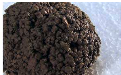
Film d'eau-ciment brillant à la surface de la boule de neige, consistance optimale.
