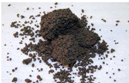
„boule de neige“ désintégrée suite à une consistance trop sèche
