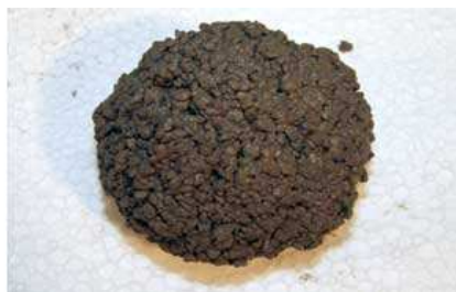
„boule de neige“ avec consistance terre-humide optimale
