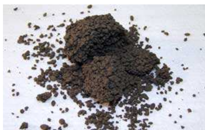
Zerfallener „Schneeball“ bei zu trockener Konsistenz
