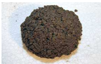
„Schneeball“ bei optimaler erdfeuchter Konsistenz
