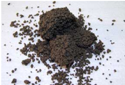
Zerfallener „Schneeball“ bei zu trockener Konsistenz
