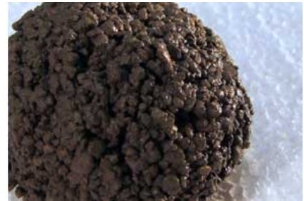
Bindemittel-/ Wasserfilm auf der Oberfläche des Schneeballs bei optimaler Konsistenz
