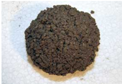
„Schneeball“ bei optimaler erdfeuchter Konsistenz
