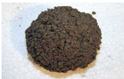
„Schneeball“ bei optimaler erdfeuchter Konsistenz
