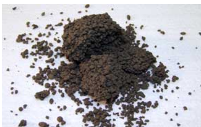
Zerfallener „Schneeball“ bei zu trockener Konsistenz
